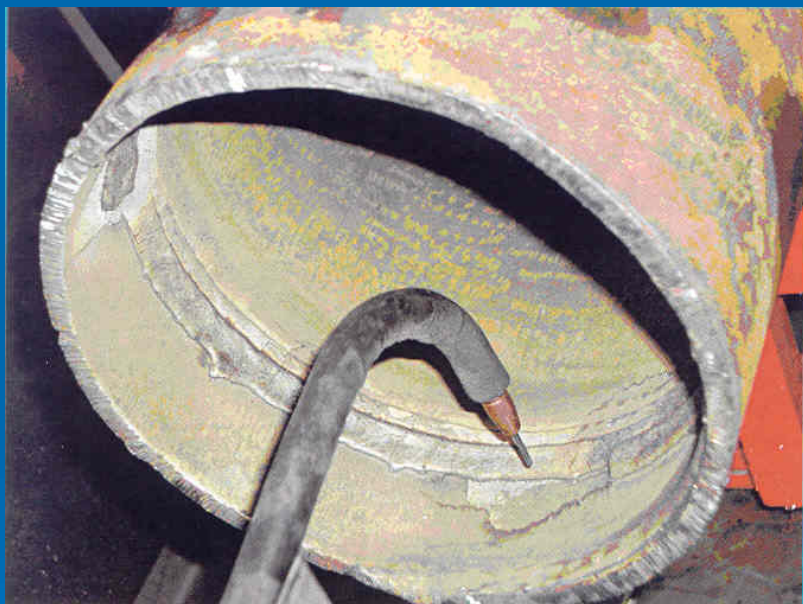
Widok procesu napawania produkcyjnego SSA drutem proszkowym TeroMatec
