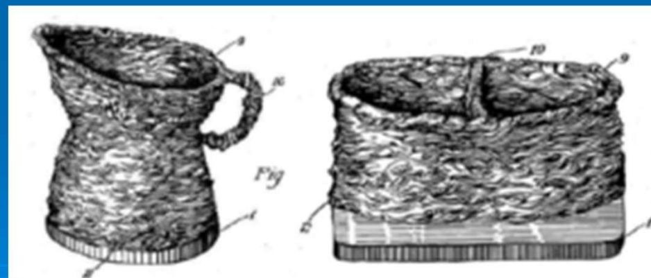
Patent z 1926 roku – zastosowanie łuku elektrycznego do wytwarzania przedmiotów 3D
